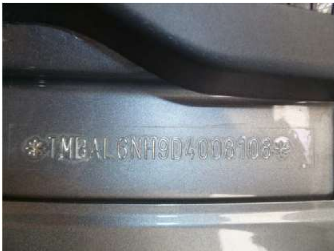
8. Detail VIN kódu vozidla na kovové části.
